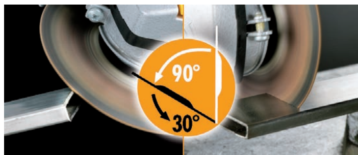
Taglio ultrasottile e smerigliatura con un solo disco
