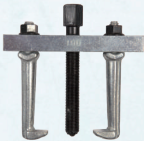
Art. 00904 Estrattori forgiati scorrevoli a 2 griffe Per meccanica - In acciaio forgiato verniciato Griffe reversibili - Blocco a vite - Per uso interno ed esterno
